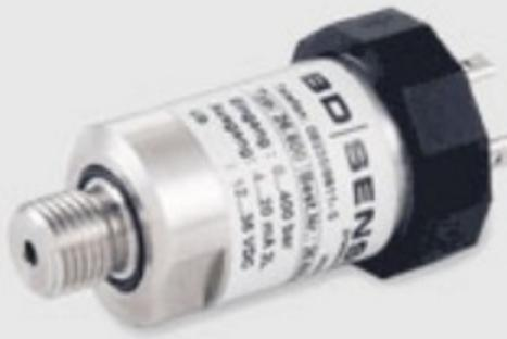
DMP 330H - экономичный датчик давления с повышенной стойкостью к перегрузкам: максимально допустимое давление составляет до 500% от номинального верхнего предела измерений. Датчик пропорционально преобразует давление рабочей среды в электрический сигнал 4...20 мА или 0...10 В.
